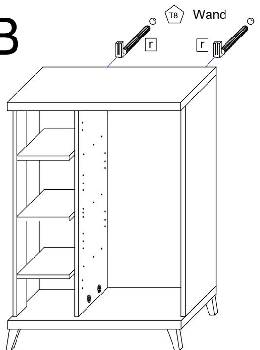
**T6** Die Schrankaufhänger dienen zur Kippsicherung des Schrankes und müssen grundsätzlich montiert werden.
