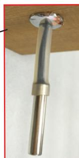
Achten Sie darauf, dass der Temperatursensor etwa 2 cm aus dem Silikonrohr heraussteht.
