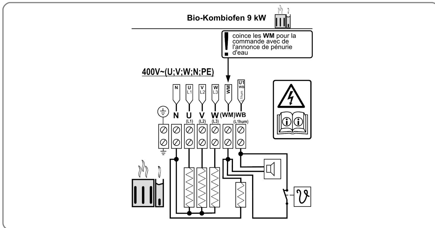
bornes de conducteur et le boîtier (terre de protection) à l'aide d'un appareil de mesure approprié. La résistance d'isolement totale entre les bornes de connecteur et le boîtier (terre de protection) doit en tout cas être supérieure à 1M $\Omega$ .
