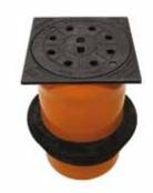
Teleskopabdeckung DN(OD) 315, Belastungsklasse B125 (12,5 t), mit Dichtmanschette, mit Lüftung
